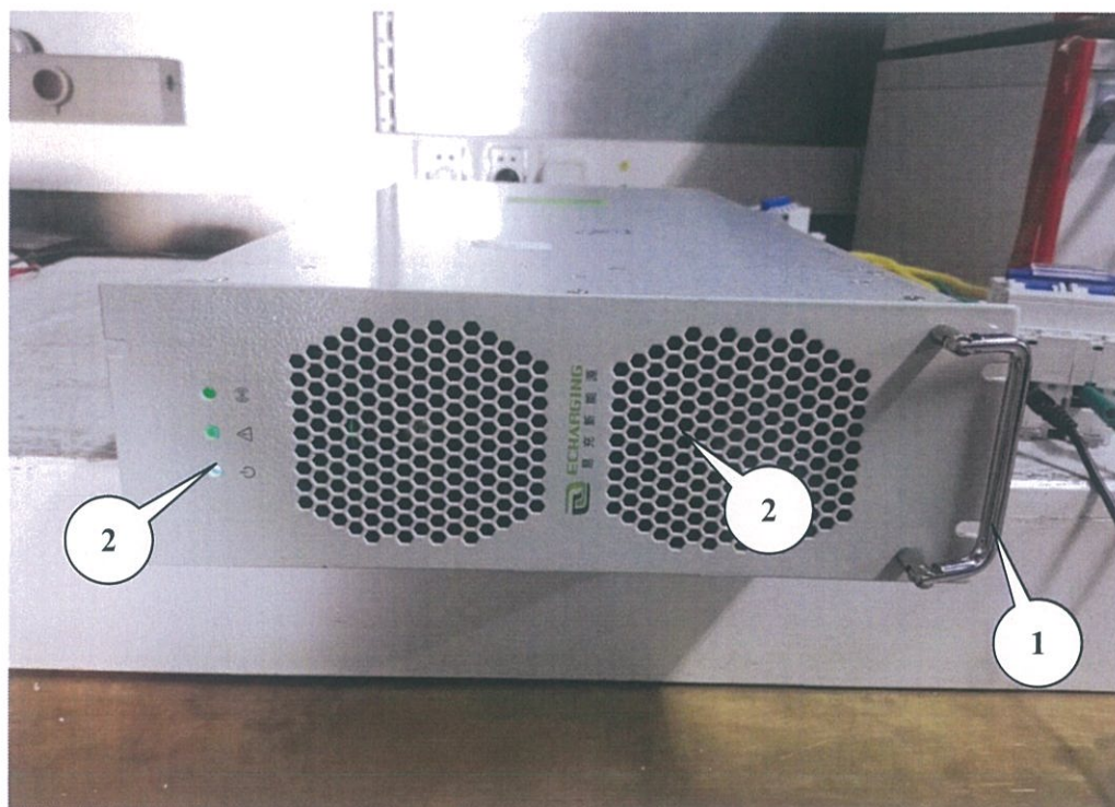
图 1: 静电放电抗扰度检验配置图及典型检验点位置图 (注: 1—接触放电部位; 2—空气放电部位)
